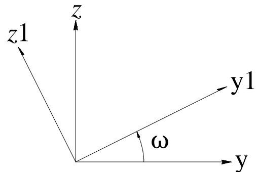
$$X_1 = \begin{bmatrix} x_1 \\ y_1 \\ z_1 \end{bmatrix} \quad M_1 = \begin{bmatrix} 1 & 0 & 0 \\ 0 & \cos(\omega) & \sin(\omega) \\ 0 & -\sin(\omega) & \cos(\omega) \end{bmatrix} \quad \text{and} \quad X' = \begin{bmatrix} x \\ y \\ z \end{bmatrix}$$
